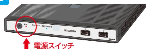
チューナーの主電源が入り、自動的にファームウェア(チューナーを動作させる内蔵プログラム)の更新確認が行われ、必要がある場合には更新作業が行われます。更新中は電源ランプが点滅(赤)します。
